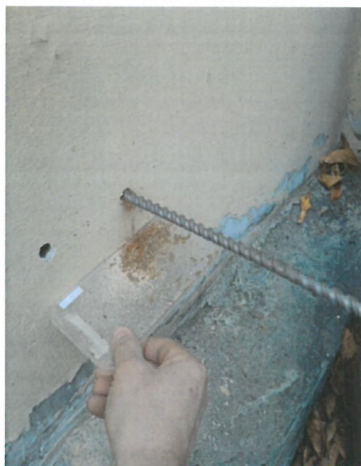
Zdj.12. Odkrywka w ścianie wschodniej wykonywana poprzez wiercenie. Stożek zwiercin do pomiaru wilgotności masowej przed pomiarem zawilgocenia miał wysokość, co najmniej 3 cm.
