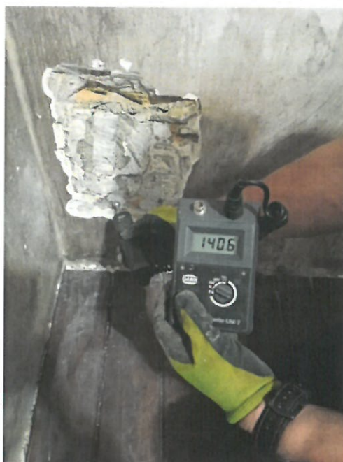
Zdj.13. Odkrywka tynku w narożu kruchty wschodniej. Zawilgocenie ściany wynosi ponad 13,5% w skali wilgotności masowej – 140,6 punktu
