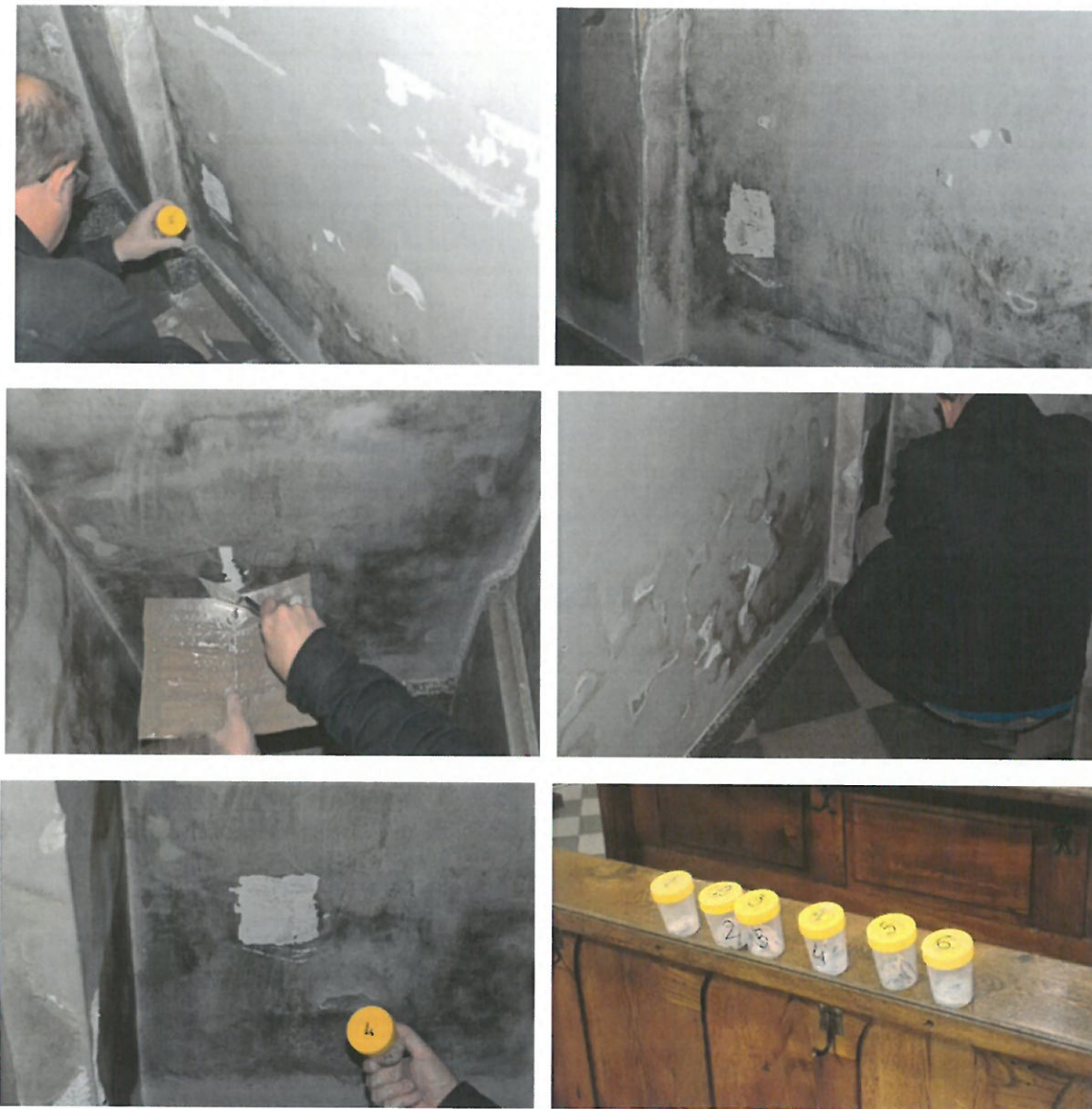
Zdj.14. Pobieranie próbek do oznaczania ilości i rodzaju soli w ścianie wschodniej, zachodniej i w ścianie południowej
