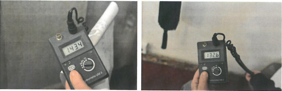
Zdj. 7. Pomiary zawilgocenia ścian nawy głównej miernikiem Gann Hydromette Uni 2, oraz względne pobieranie zwiercin do pomiarów strukturalnego zawilgocenia przegród
