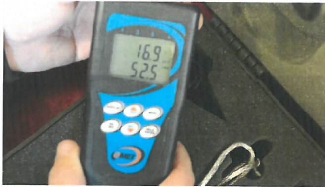
Zdj.8. Pomiar temperatury i wilgotności względnej, 100 cm pod poziomem posadzki – październik 23 r.
